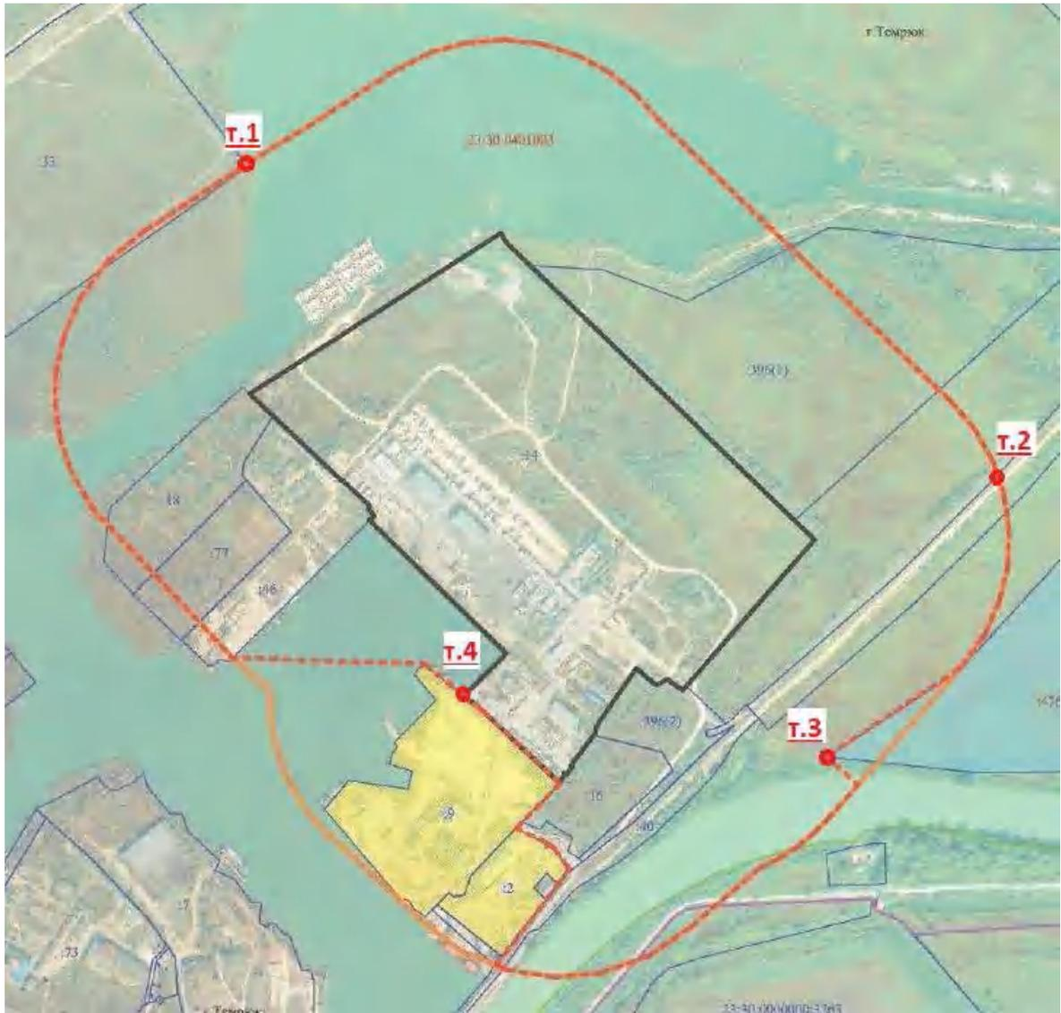
Рисунок 7 – Карта-схема с точками мониторинга атмосферного воздуха и измерения уровней шума
