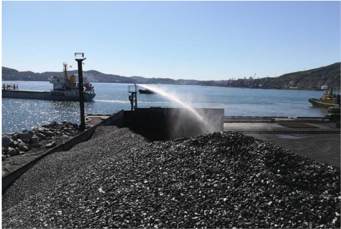
Рисунок 9 – Работа по пылеподавлению при помощи пожарных лафетов
