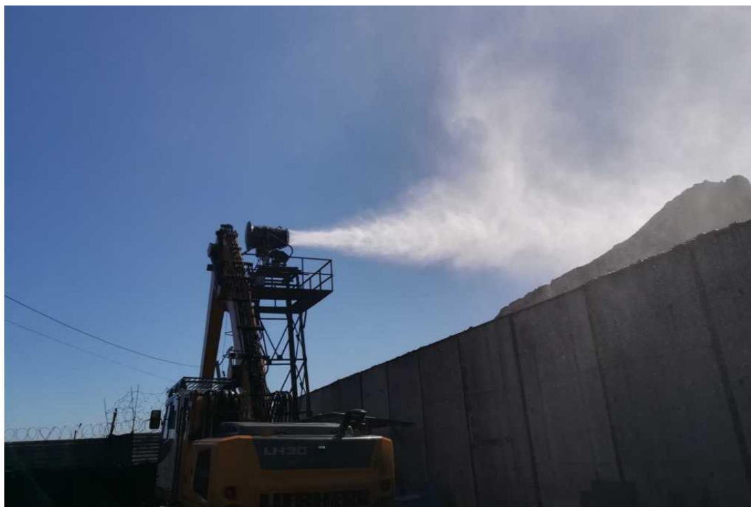
Рисунок 8 – Универсальная гибридная пушка пылеподавления (модель SKADO Super Polecat)
