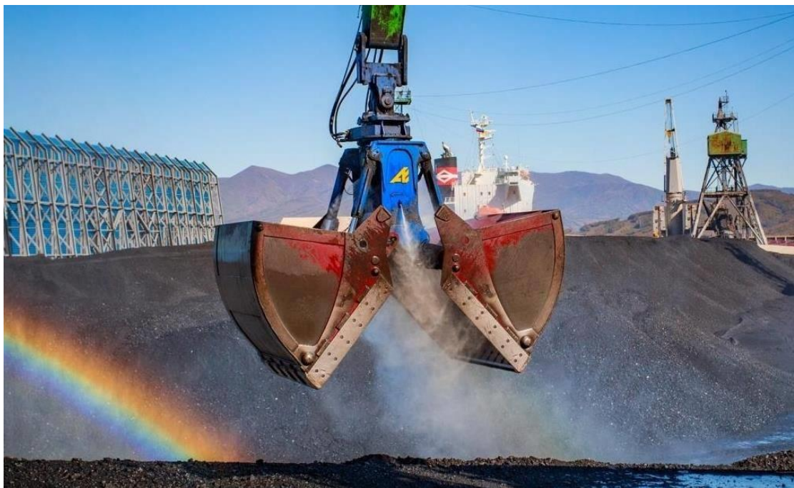
Рисунок 2.5.3 – Работа грейфера со встроенной системой пылеподавления ARDEN JET
