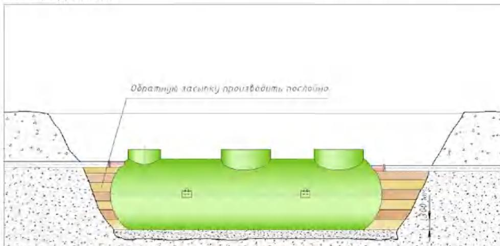
Рис.4. Послойная обратная засыпка оборудования
